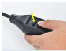
3. Stisknutím tlačítka «TEST» tlačítko, kontrolka zhasne.
