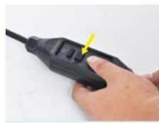
4. Stisknutím tlačítka «Reset» tlačítko, kontrolka svítí červeně. RCD pracuje správně.
