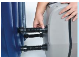
8) Připojte čerpací jednotku k vířivce pomocí 3 šroubovacích konektorů. Zkontrolujte, zda se značení na čerpadle a na vířivce shodují.
