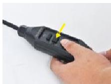
4. Stiskněte tlačítko RESET, ukazatel se rozsvítí červeně. RCD funguje správně.
