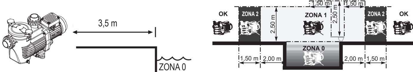
Instalar a bomba num local ventilado e seco; o motor precisa que o ar circule livremente à volta da bomba para permitir a sua ventilação natural. Verificar regularmente que objectos, folhas ou quaisquer outros elementos não obstruem a refrigeração do motor.
