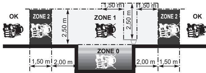
Установите насос в проветриваемом сухом месте. Для естественной вентиляции двигателя необходимо обеспечить свободную циркуляцию воздуха вокруг него. Необходимо периодически проверять, что охлаждению двигателя не препятствуют какие-либо объекты, листья и прочие предметы.
