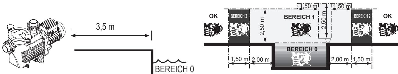
Pumpe an einem belüfteten, trockenen Ort aufstellen. Für einen ordnungsgemäßen Betrieb des Motors muss die Luft frei um die Pumpe zirkulieren können, um ihn auf natürliche Weise zu belüften. Regelmäßig prüfen, ob Gegenstände, Blätter oder andere störende Objekte die Motorkühlung verstopfen.
