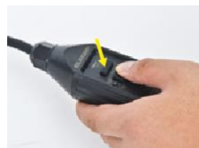
3. Stiskněte tlačítko «TEST», kontrolka zhasne.
